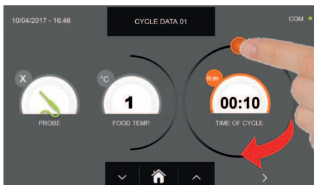
a- Programmation de la durée du cycle
