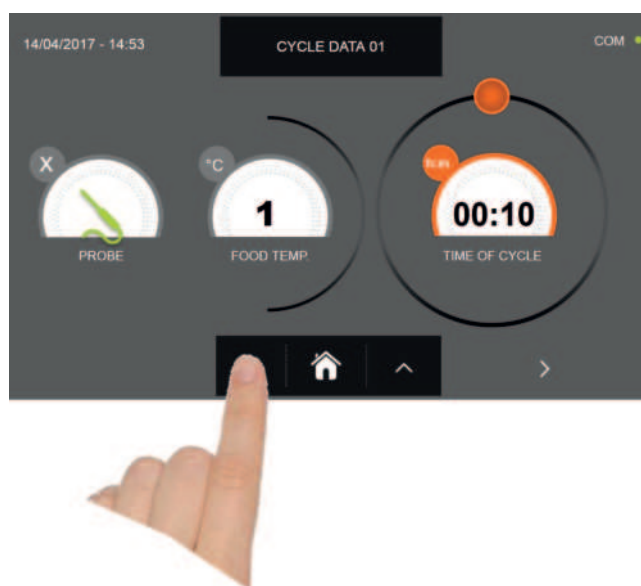
a- Programmation de la durée du cycle
