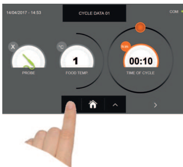
a- Programmation de la durée du cycle
